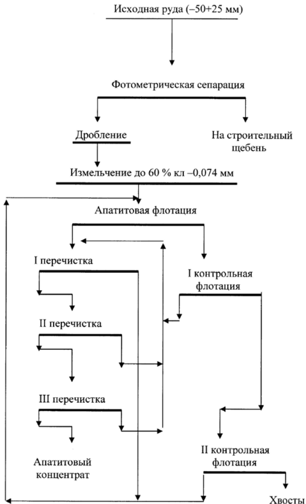
Схема обогащения руды с предварительной фотометрической сепарацией
