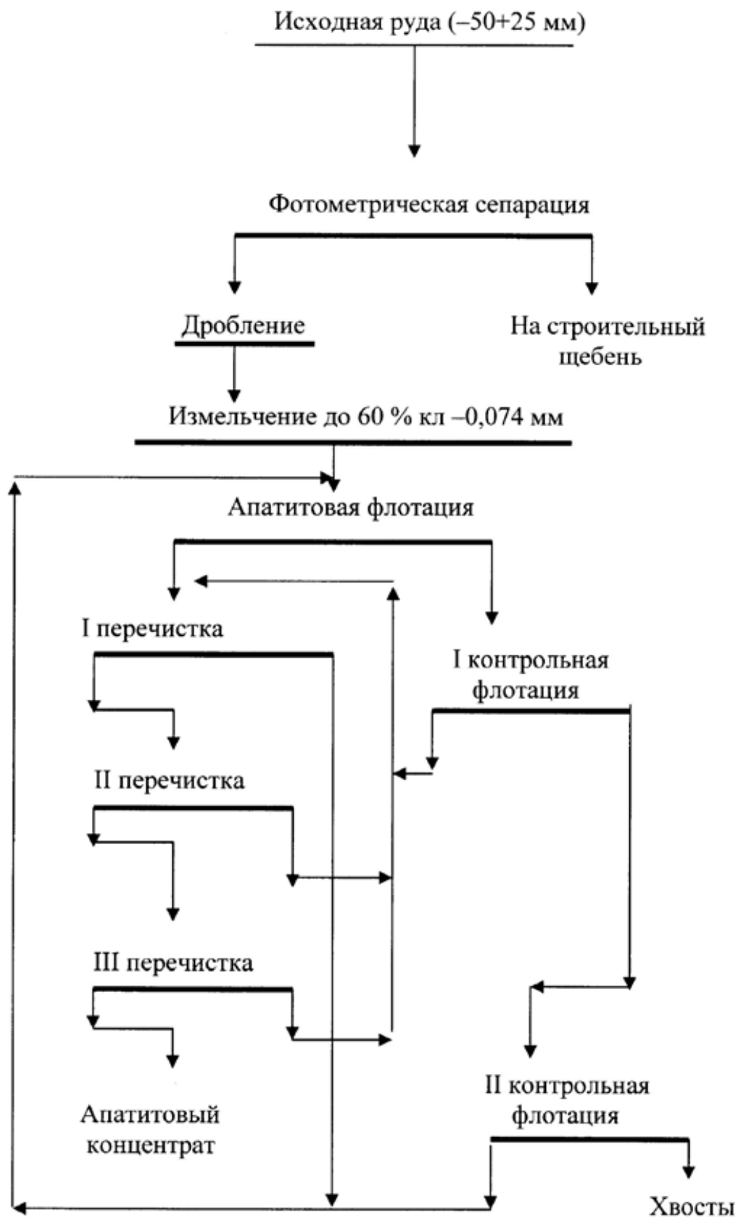
Схема обогащения апатитовой руды с предварительной фотометрической сепарацией
